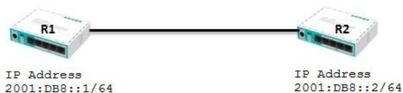
Gambar 4.7 : Konfigurasi IPv6 pada Router Mikrotik
